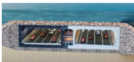
Рис. 3. Поперечное сечение восьмиполосного тоннеля, проходящего по дну дельты Жемчужной реки
