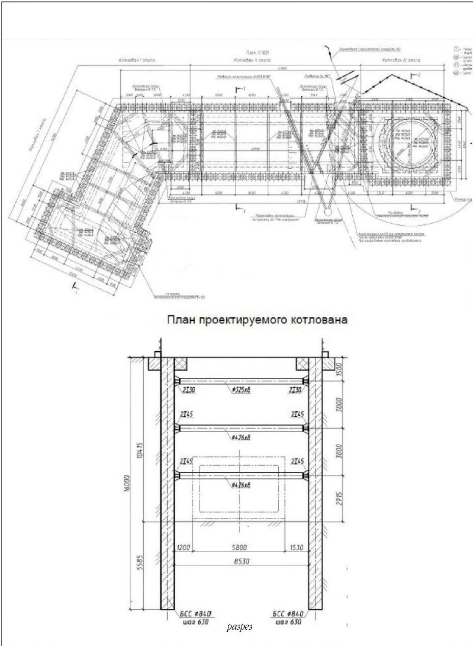
Рис. 5. Крепление котлована для сооружения вентканала
