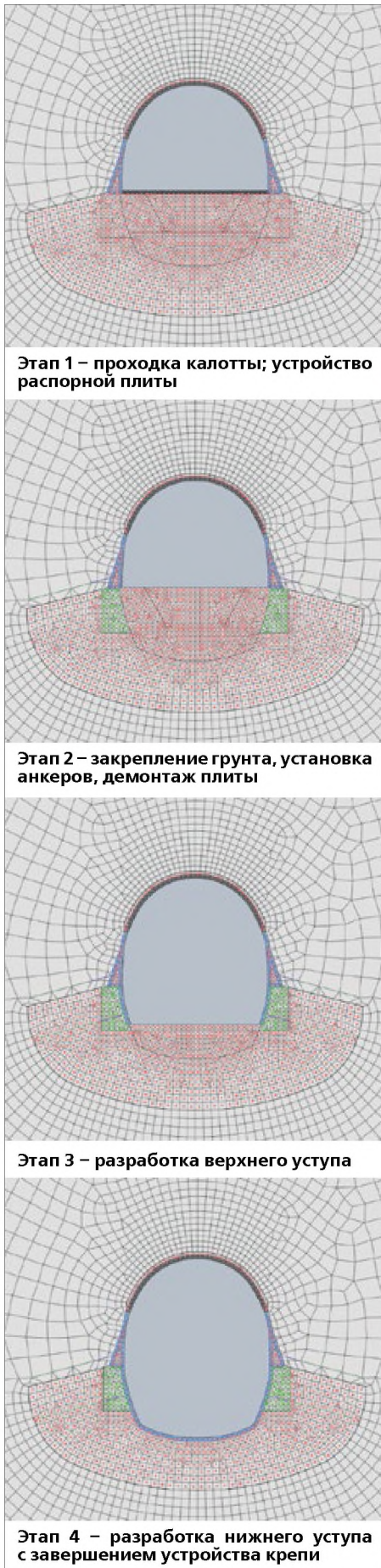
Рис. 5. Расчетные схемы по этапам раскрытия выработки (второй вариант расчета). Зелёным цветом показана зона закрепления грунта. Красным – зона замачивания
