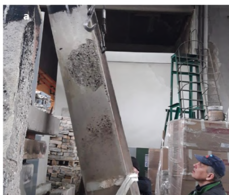
Рис. 8. Образцы с добавлением полипропиленовой микрофибры после испытаний
