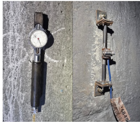
Рис. 4. Компаратор с индикатором часового типа и струнный деформометр
