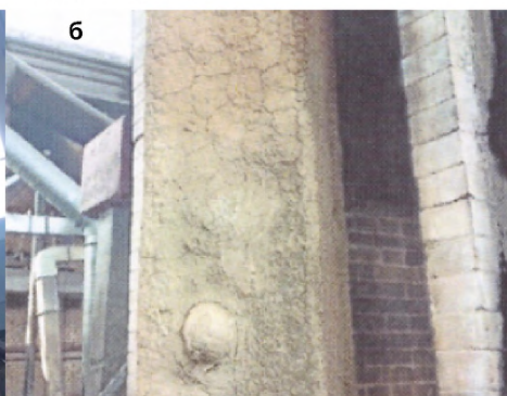
Рис. 7. Образцы железобетонных колонн после огневых испытаний с огнезащитным материалом: а – огнезащитные плиты; б – штукатурка
