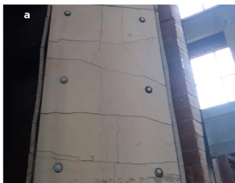
Рис. 7. Образцы железобетонных колонн после огневых испытаний с огнезащитным материалом: а – огнезащитные плиты; б – штукатурка
