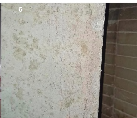
Рис. 8. Образцы с добавлением полипропиленовой микрофибры после испытаний
