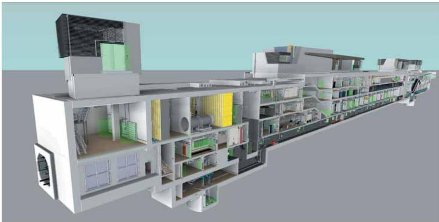
Рис. 11. Калининско-Солнцевская линия. Цифровая модель станционного комплекса «Внуково»
