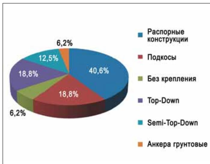
Рис. 5. Анализ применяемых систем раскрепления котлованов в плотной городской застройке
