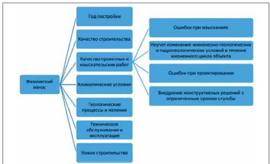
Рис. 2. Параметры, определяющие физический износ подземных сооружений
