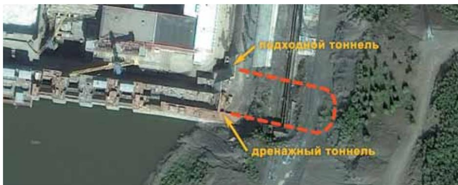
Рис. 2. Местоположение подходного-дренажного тоннеля
