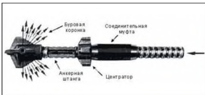
Рис. 3. Схема анкера из ТВШ
