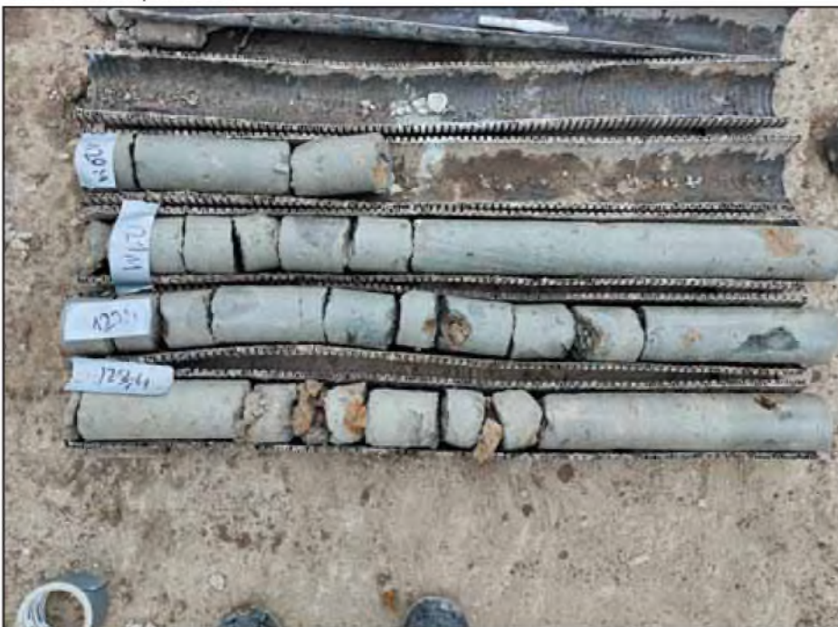
Рис. 7. Выход керна без песчаных прослоев на опытном участке при строительстве станции «Крымская» Московского метрополитена
