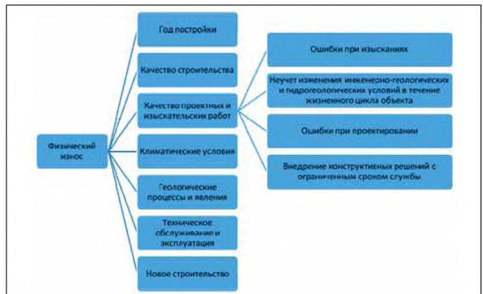
Рис. 2. Параметры, определяющие физический износ подземных сооружений
