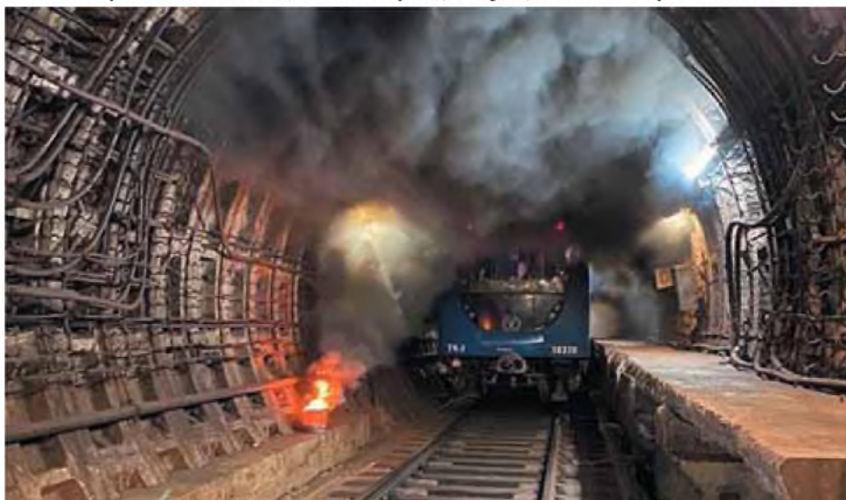
Рис. 8. Экспериментальные исследования пожара в действующем тоннеле метрополитена
