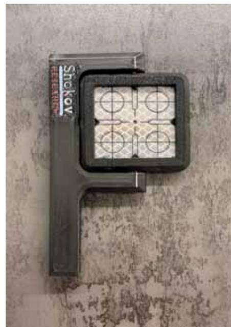
Поворотная двухсторонняя марка (крепится на обделке тоннеля)
