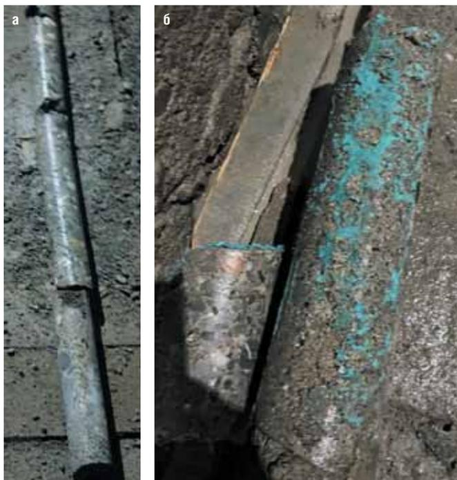
Рис. 8. Керны: а – после уплотнительной цементации; б – после нагнетания акрилатного геля (гель голубого цвета)
