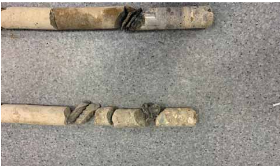
Рис. 4. Керны: вверху из верхнего шпура (четыре слоя эластопласта) и из нижнего шпура два оплавленных изоляционных слоя стены МФК
