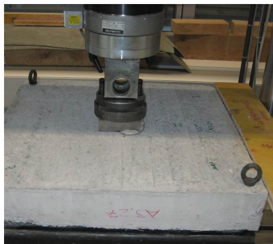
Рисунок 1 Получение трещин в тестируемой прерванной квадратной панели EFNARC. Тест прерван при деформации 3 мм
