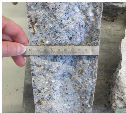
Рисунок 8 Фото квадратной панели, армированной стальным волокном (A1), после года воздействия соли ( \text{NaCl} )-раствора (3%) после тестирования квадратной панели.
