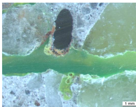
Рисунок 9 Микрфотграфия стальной фибры вблизи трещин (пропитанной для сохранения зеленой смолой) на расстоянии 35 мм от поверхности после 1 года экспозиции в растворе \text{Na}_2\text{SO}_4 (A1).
