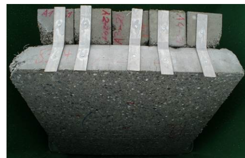
Рисунок 3 Установка экспозиции с применением жидких растворов (вверху), покрытия (в центре) и различных образцов (квадратных панелей для механических испытаний и призм для микроскопии, внизу).
