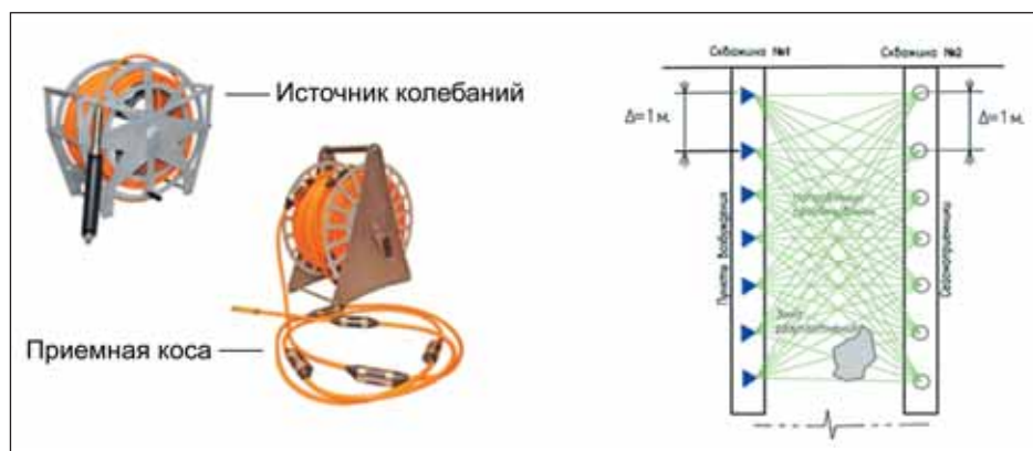
Рис. 3. Принципиальная схема производства МСП и скважинные зонды
