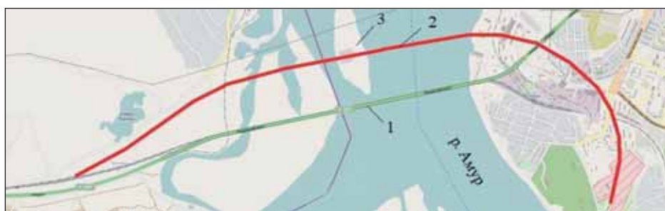
Рис. 1. План участка для строительства мостового перехода и тоннеля через р. Амур: 1 – мостовой переход; 2 – тоннель; 3 – остров
