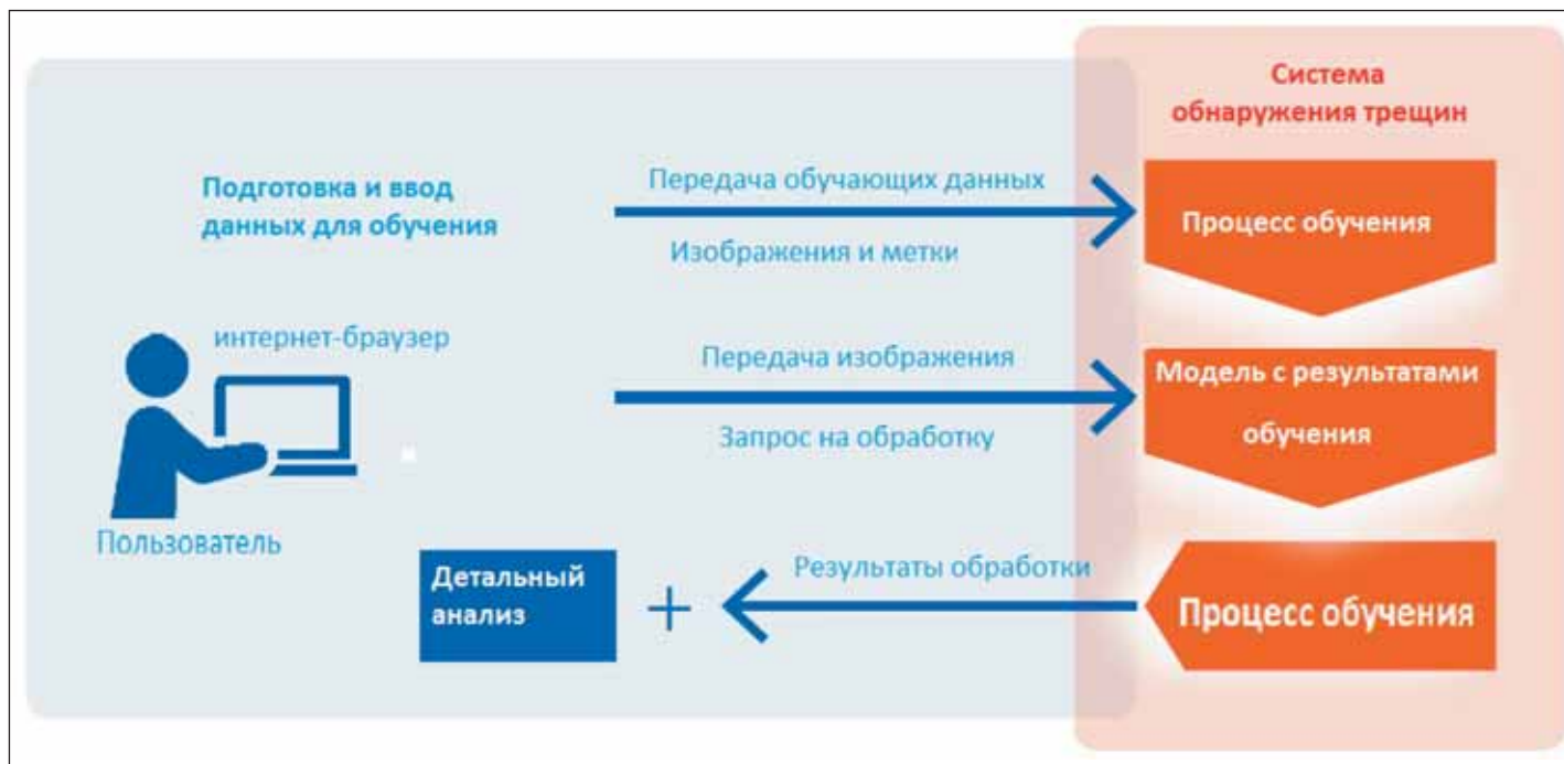
Рис. 2. Технология процесса автоматического распознавания трещин в обделке тоннеля
