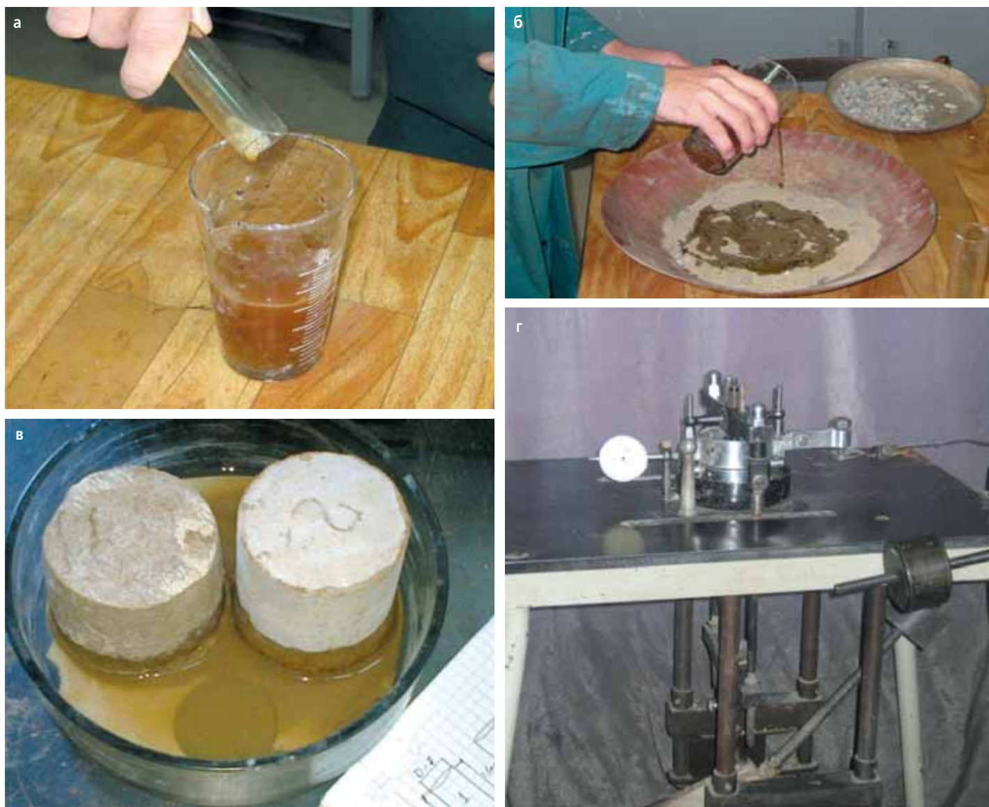
Рис. 3. Подготовка образца грунта со стабилизаторами для определения прочности характеристик: а – подготовка Т-RRP; б – смешение грунта с Т-RRP; в – проверка водонасыщения; г – прибор ГПП-30 Маслова-Лурье
