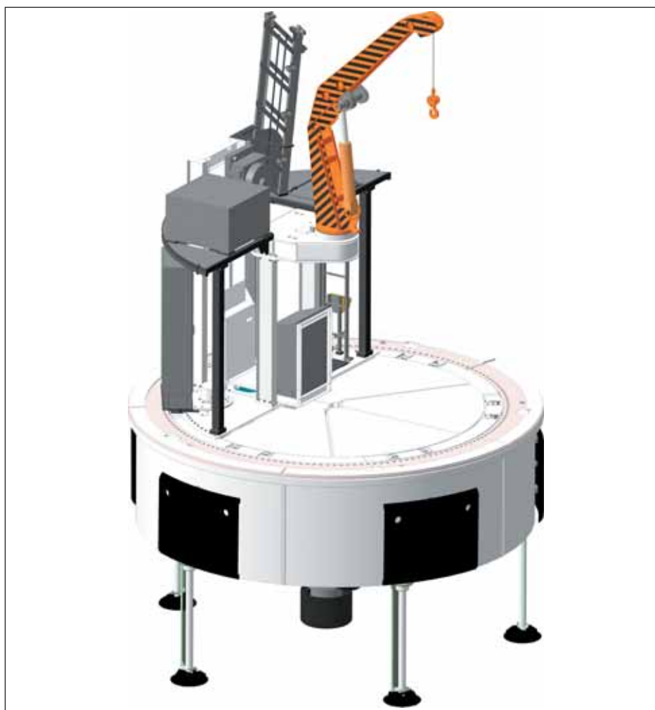
Рис. 1. Стволпроходческий комбайн (вид 1)
