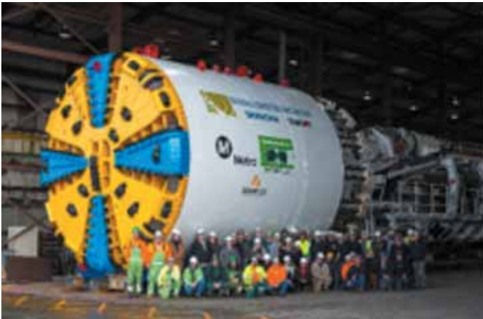
Рис. 3. 18 июля 2017 г. ТПМК S-952 «Анджели» завершил проходку первого участка длиной 1,7 км для строительства Регионального транспортного коридора. Сборка проходческого щита осуществлялась дочерним предприятием «Херренкнехт» в США – «Таннелинг Сервисез Инк.», Сизлт
