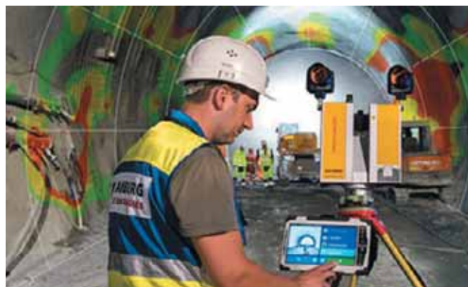
Система Dibit на геодезическом штативе (треноге)
