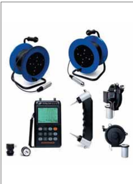
Рис. 3. Оборудование для обследования бетона – Пульсар-2.2 «ДБС»
