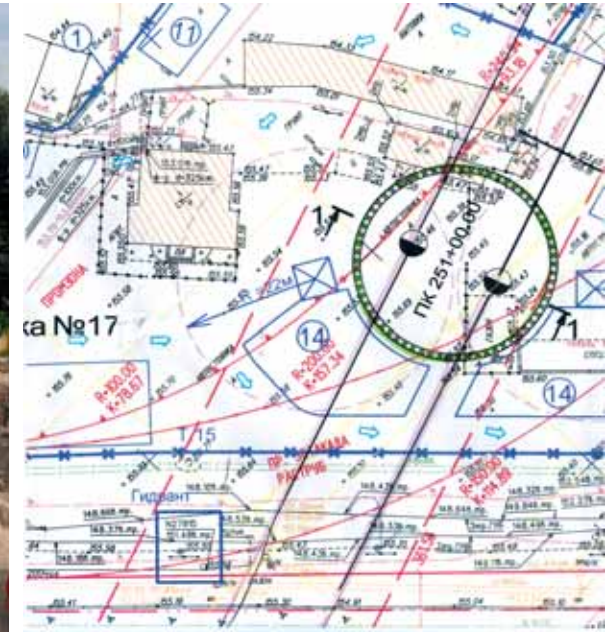
Рис. 3. Размещение кругового котлована на ПК 251+00 по оси трассы БКЛ
