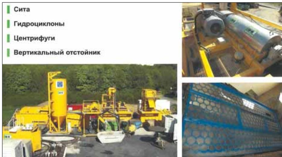
Рис. 2. Сепарационная установка для VSM
