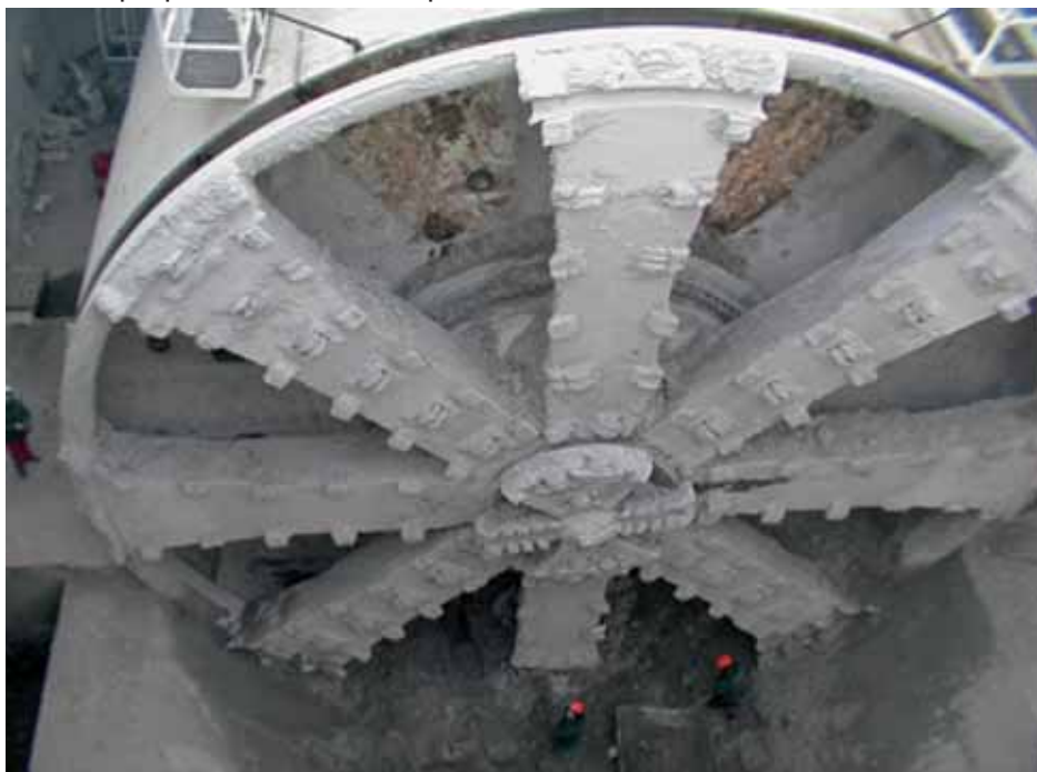
Рис. 4. Вид ротора большого щита после проходки по пластам известняка
