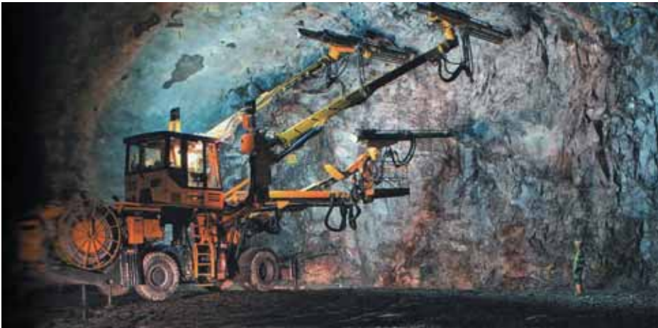
Рис. 5. Механизация БВР при проходке
