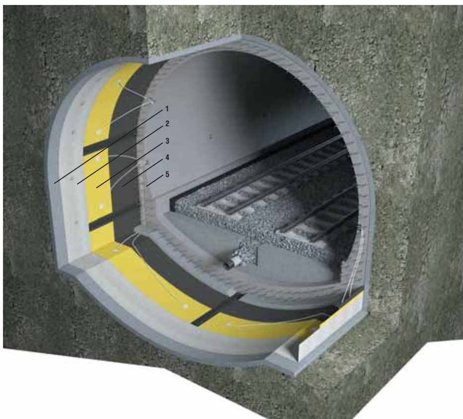
Рис. 4. Применение защитной мембраны LOGICBASE V-PT в гидроизоляционной системе тоннеля: 1 – бетонная крепь; 2 – геотекстиль; 3 – ПВХ мембрана LOGICBASE V-SL; 4 – ПВХ мембрана LOGICBASE V-PT; 5 – вторичная обделка
