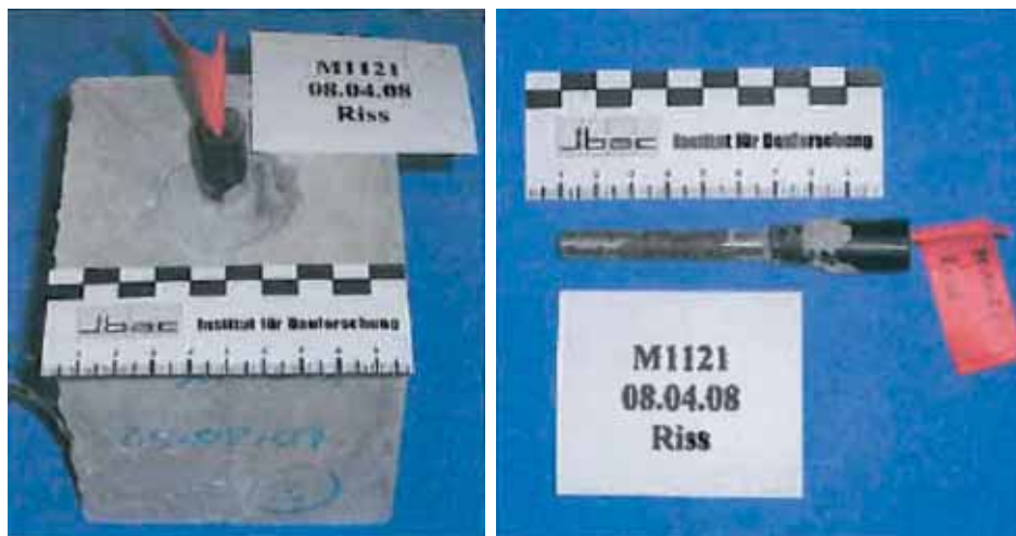
Рис. 1. Результаты испытаний гидрогеля MC-Injekt GL-95 TX на агрессивность к арматуре в бетонном кубике по методике IBAC: объем коррозии до 40 раз меньше по сравнению с объемом коррозии при контакте с водой. Материал разрешен для применения в зонах контакта с арматурой и чугунных тубингов
