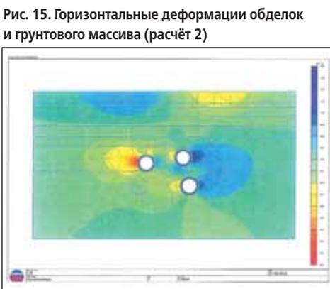
Рис. 15. Горизонтальные деформации обделок и грунтового массива (расчёт 2)
