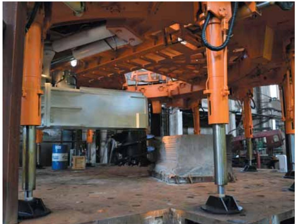
Рис. 4. Тестирование рабочего органа АСП-8 для резки пород в заводских условиях
