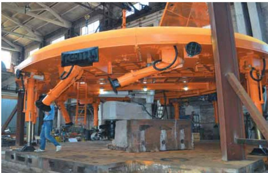
Рис. 5. Проверка механизма складывания вертикальных домкратов
