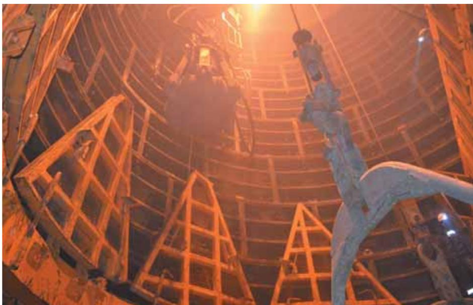
Рис. 6. Положение настилов монтажной платформы при очистных работах
