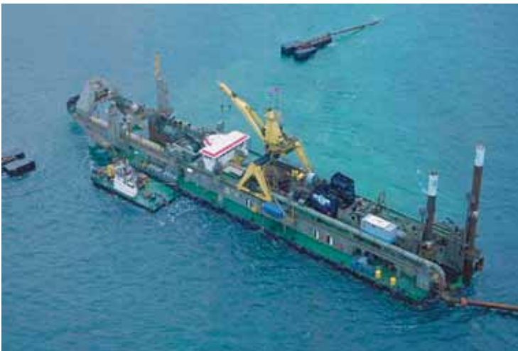
Рис. 15. Многофункциональная баржа с оборудованием для углубления и выравнивания траншеи и земснаряд для разработки твёрдых пород грунта
