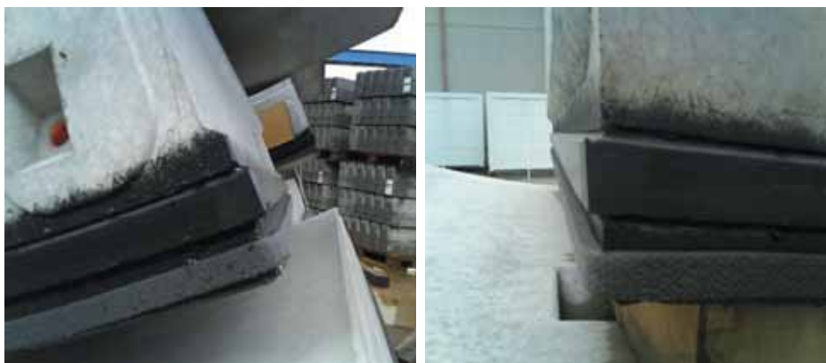
Рис. 9. Углы смежных замкового и предзамкового блоков. «Скрученный угол» способствует лучшему контакту поверхностей при монтаже
