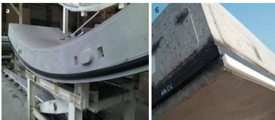
Рис. 10. Примерка резинового уплотнителя, пример маркировки на оклеенном блоке
