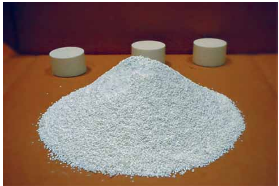
Рис. 4. Материал Groutmaster в виде гранулированного порошка
