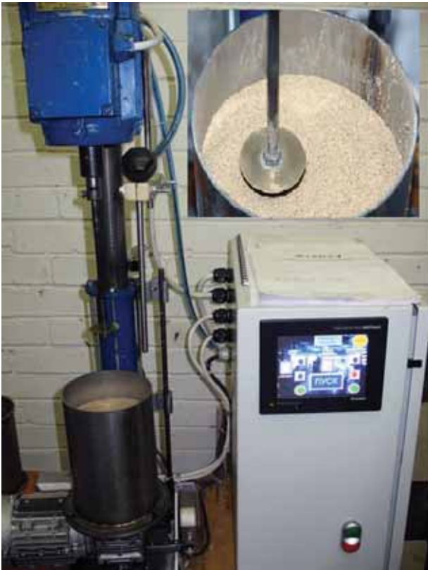
Рис. 5. Стенд для определения смазывающих свойств пенных реагентов
