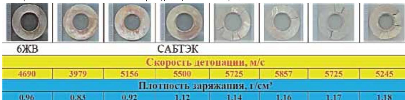
Рис. 1. Бризантность ЭВВ «Сабтэк» в зависимости от скорости детонации и плотности заряжания
