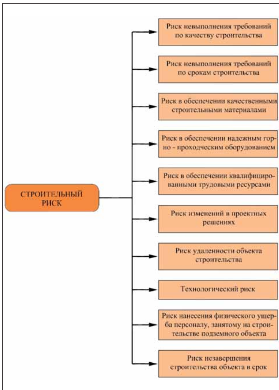
Рис. 3. Виды строительного риска при возведении подземных сооружений
