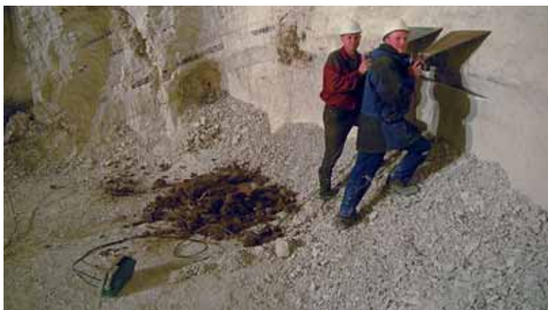
Рис. 5. Пример выполнения ЭМИ СШП зондирования в забое
