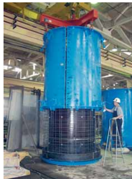
Опалубочная форма для производства железобетонных труб на заводе «Метробетон»
