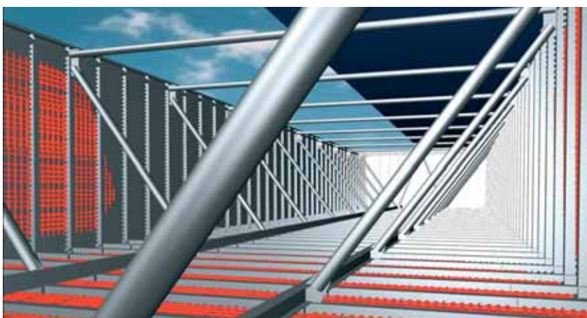
Стальной каркас секции тоннеля, подготовленный к транспортировке
