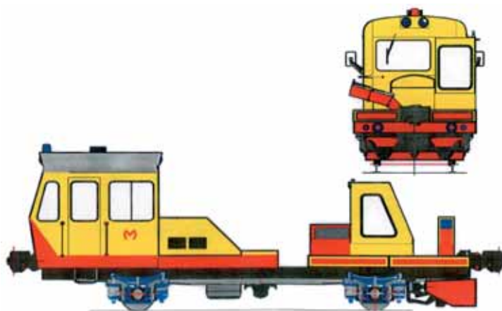
Снегоочиститель шнекороторный на базе АГМс-тм
