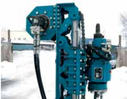
Планетарный редуктор с тяговым усилием 40 кН
