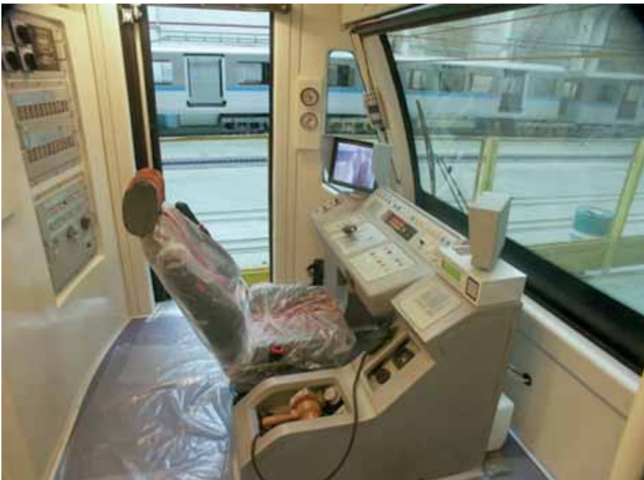
Кабина машиниста электропоезда метрополитена «Русич», изготовленная ЗАО «Лидер-Тюнинг»
