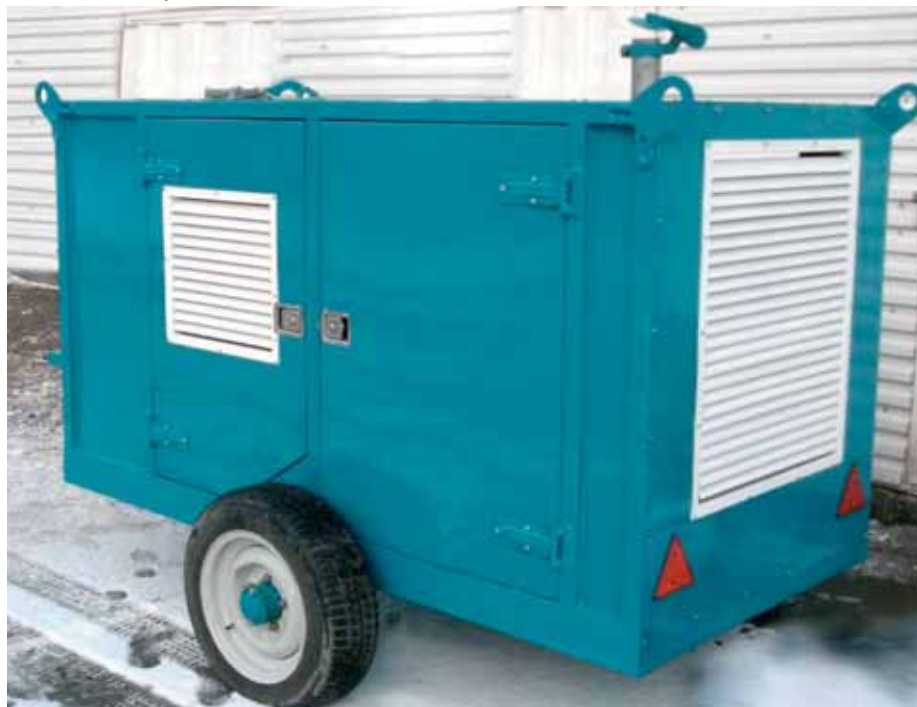
Внешний вид гидростанции
