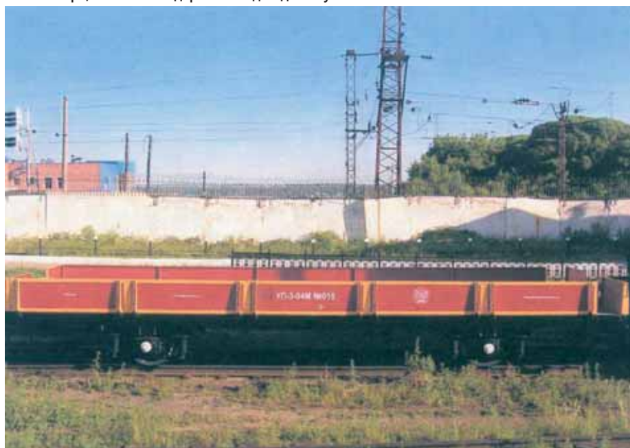
Прицеп грузовой УП-3-04М. Предназначен для эксплуатации в метрополитене, при строительстве линий метро, на железных дорогах и подъездных путях
