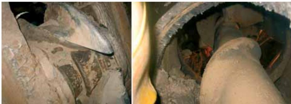
Износ шнекового конвейера ТПМК
