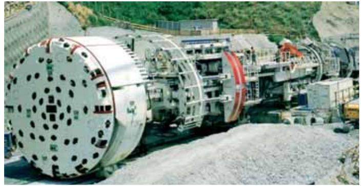
Рис. 3. Тоннелепроходческий механизированный комплекс фирмы «Херренкнехт» диаметром 9,6 м
