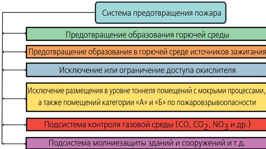
Рис. 3. Система предотвращения пожара
