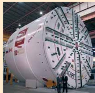
лом 30° будет проложен с помощью механизированного тоннелепроходческого комплекса (ТПМК). Он состоит из мощного ротора и закрепленных на нем шарошек и резцов. Использование ТПМК сократит сроки работ до шести-восьми месяцев.
