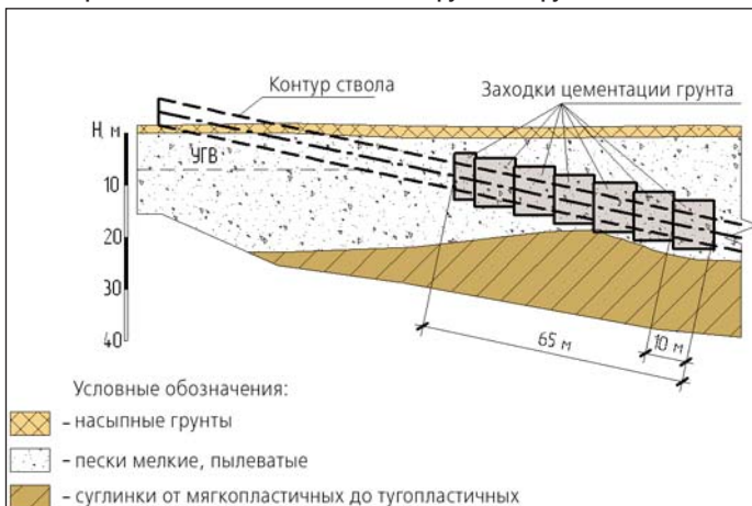
Рис. 1. Принципиальная схема цементации грунтов вокруг наклонного ствола
