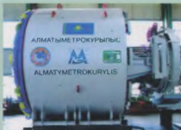
ТПМК для строительства метрополитена в г. Алматы, Казахстан
