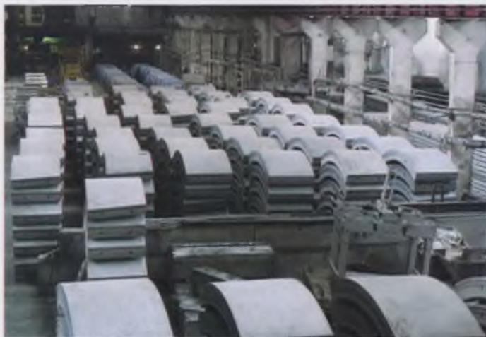
Готовые блоки для сервисного тоннеля Серебряноборских тоннелей
