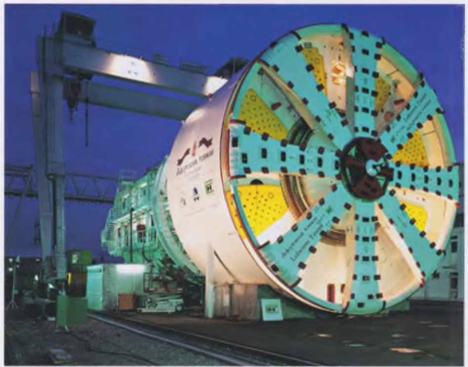
Щит «Херренкнехт» диаметром 14,2 м для проходки Лефортовского и Серебряноборских тоннелей
