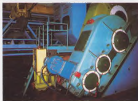
Рис. 7. Для установки привода эскалатора ЭТ-2(М) нужны сложные фундаменты и обширные машинные помещения
