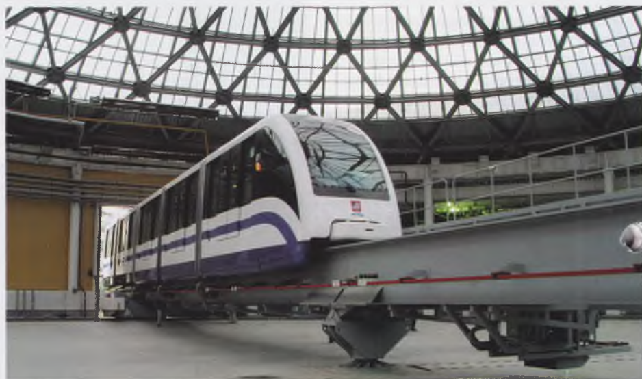
Поезд ММД въезжает на трансбордер
