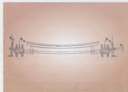
Рис. 3. Деформация ступени под действием усилий от натяжения цепи
