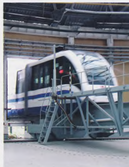
Состав выезжает с трансбордера на линию
