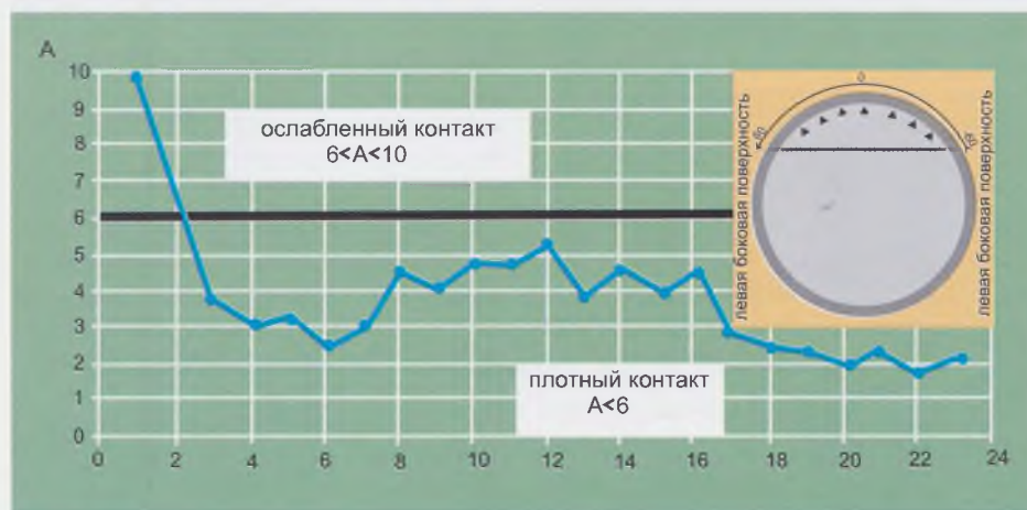
Рис. 1. Оценка контакта «обделка – тампонажный раствор» методом акустической добротности
