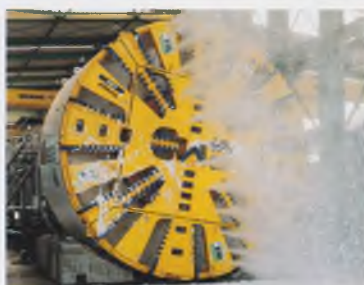
Щит с грунтопригрузом, Мадрид, Испания, Ø 9,33 м
