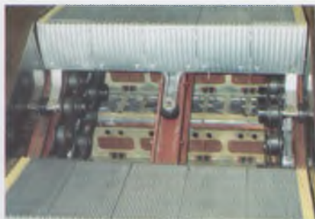
Рис. 9. Основные бегунки и тяговые цепи-рейки эскалатора ЭТХ перенесены в габарит настила ступени
