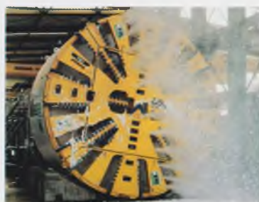
Щит с грунтопригрузом, Мадрид, Испания, \varnothing 9,33 м
