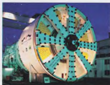
ТПК для Лефортовского тоннеля \varnothing 14,2 м
