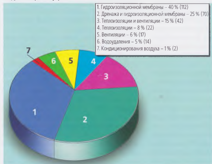
Рис. 1. Отказ элементов гидроизоляционной системы подземных и заглубленных сооружений (280 штук)
