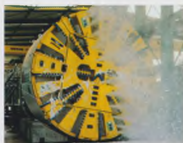
Щит с грунтопригрузом, Мадрид, Испания, \varnothing 9,33 м
