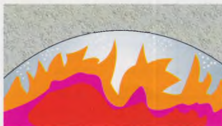
3. Вода появляется в виде пара на горячей поверхности и в виде конденсата на холодной, когда температура бетона только начинает повышаться
