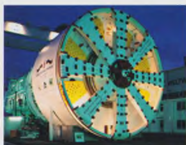
ТПМК для Лефтортовского тоннеля \varnothing 14,2 м
