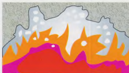
5. Отслаивание продолжается по мере воздействия на бетон, т. е. по мере повышения температуры бетона
