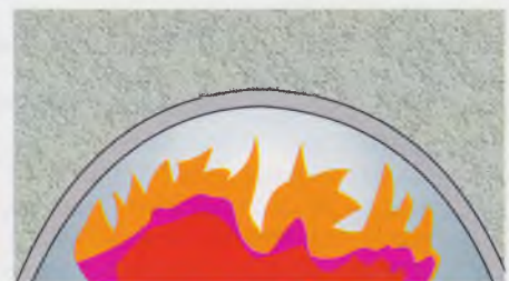
6. Тоннельная конструкция, защищенная от отслаивания огнезащитным покрытием
