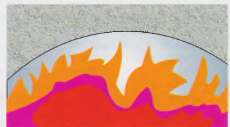
4. Отслаивание начинается, когда бетон резко высыхает отдельными местами
