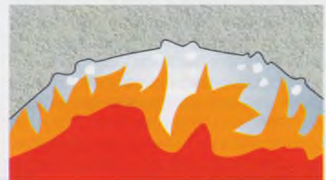
2. Водяной пар начинает проникать через капилляры по мере нагрева бетона
