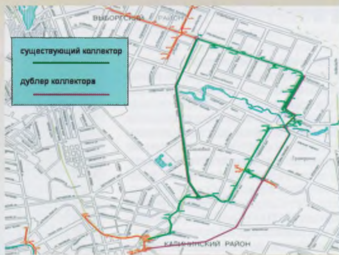
План трассы строящегося коллектора
