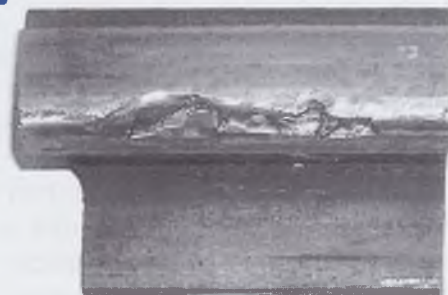
Рис. 1. Выкрашивания металла в рабочей выкружке головки рельса с наклепанным слоем
