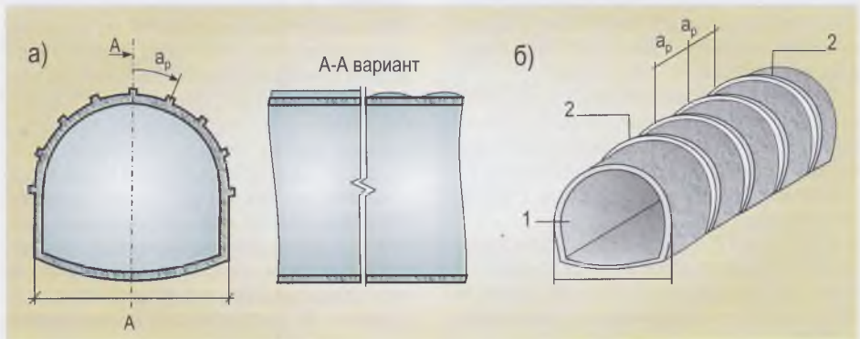
Рис. 1. Конструкции обделок с продольными (а) и поперечными (б) ребрами жесткости: 1 – оболочка; 2 – ребра жесткости; a_p – шаг ребер жесткости
