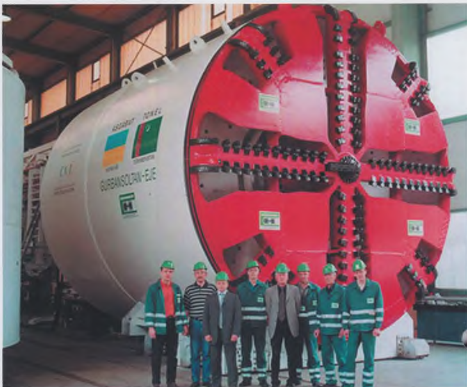
Рис. 5. Приемка ТПМК «Херренкнехт» диаметром 6 м на заводе в Шванау, Германия
