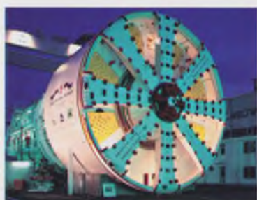
ТПМК для Лефортовского тоннеля \varnothing 14,2 м
