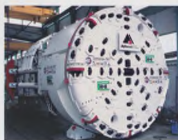
ТПМК для скальных пород, Готтард, Швейцария \varnothing 8,83 м
