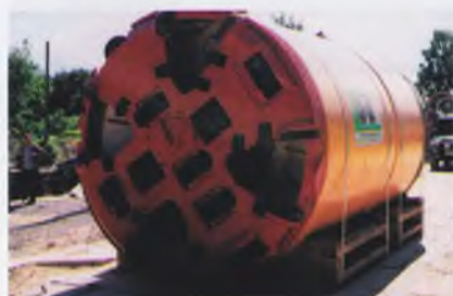
Режущая часть щита AVN-2000
