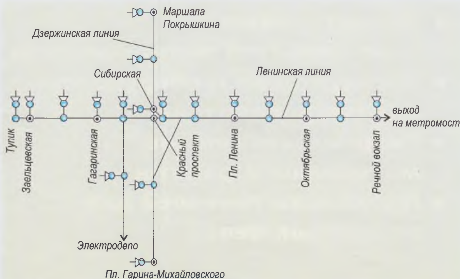
Рис. 1. Схема вентиляции правобережной части Новосибирского метрополитена
