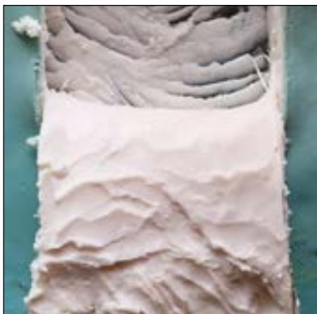
Рис. 11. Остатки геля, попавшие из соседних опытных участков
