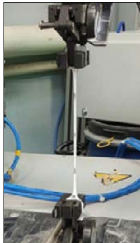
Рис. 19. Фрагменты процесса испытания материала HansaCryl Gel 3 Plus
