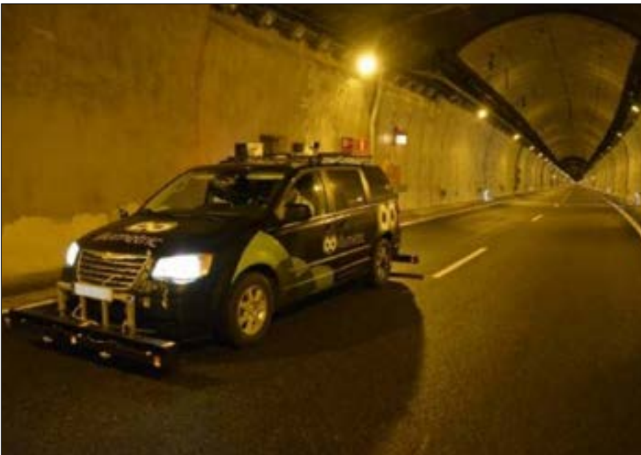
Рис. 4. Высокоэффективная система, оснащенная раздельным люксметром, установленным на высоте 30 см над уровнем проезжей части для оценки освещенности при максимальной скорости движения
