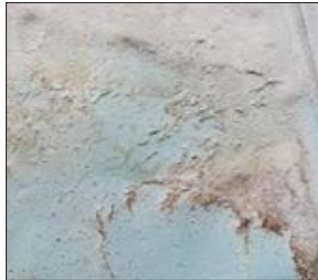
Рис. 10. Градиент изменения цвета метилметакрилатного геля
