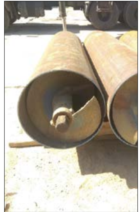
Рис. 8. Пилотная буровая головка и обсадная труба со шнеком
