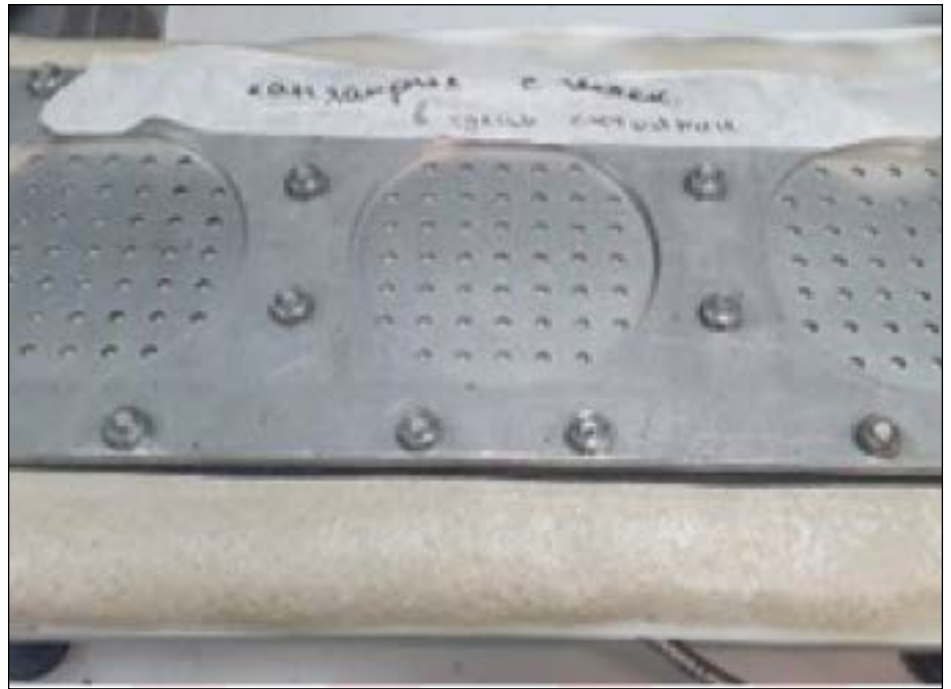
Рис. 20. Материал HansaCryl Gel 3 Plus с геотекстилем в сухом состоянии в процессе испытания
