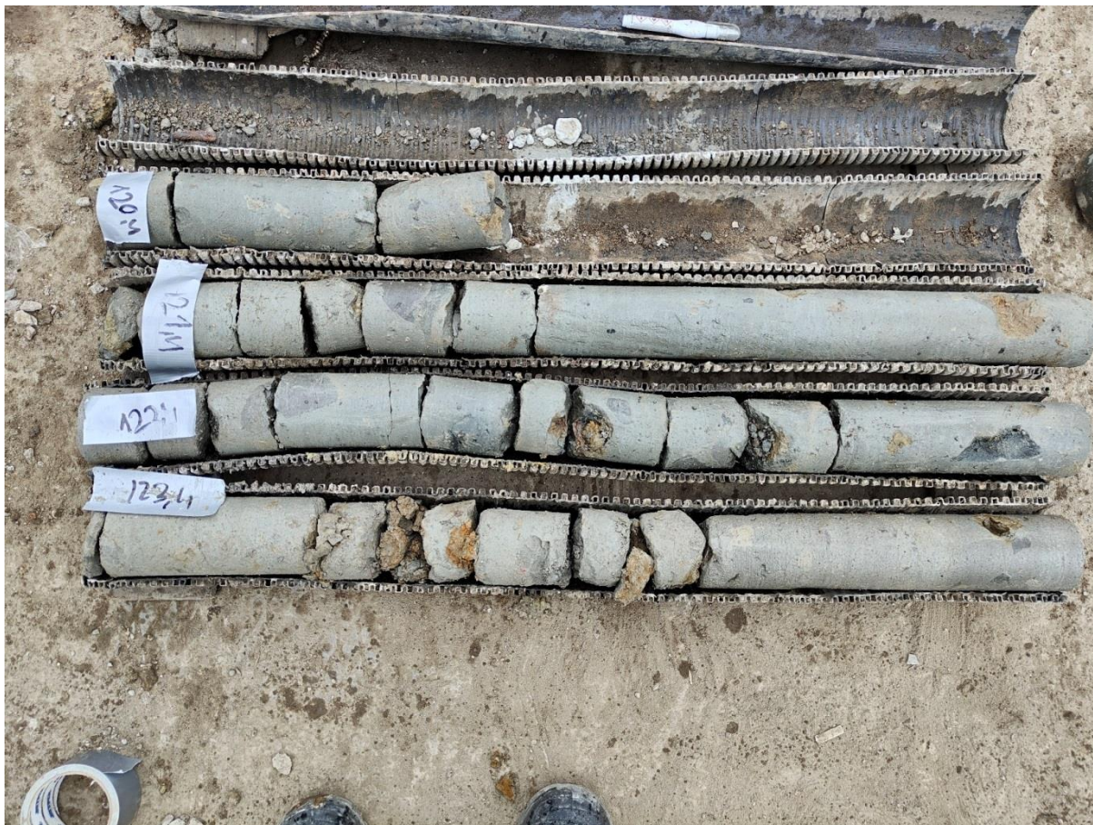
Рис. 6. Выход керна без песчаных прослоев на опытном участке при строительстве станции «Крымская» Московского метрополитена
