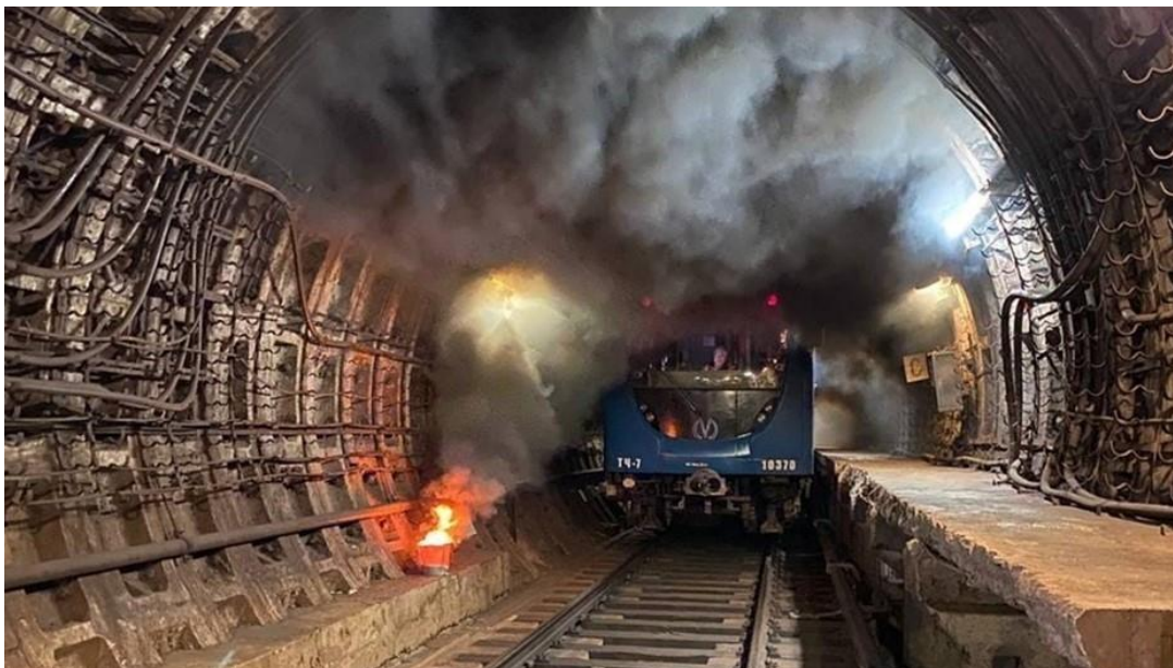
Рис. 7. Экспериментальные исследования пожара в действующем тоннеле метрополитена
