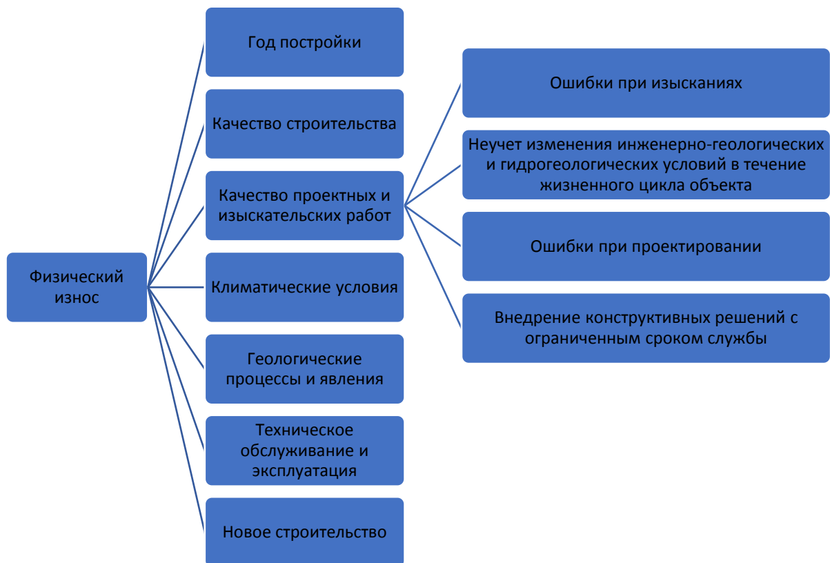
Рис. 2. Параметры, определяющие физический износ подземных сооружений
