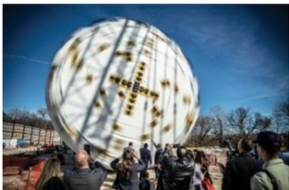
Крупнейший, когда-либо работавший в США, ТПМК для твердых пород с диаметром головной части 11,6 м не-
