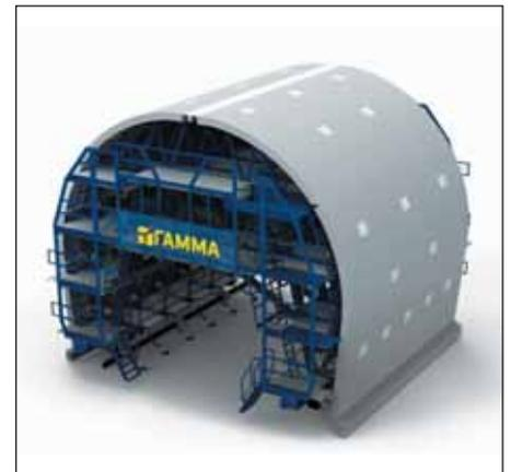
Рис. 2. Визуализированная 3-D модель самоходной гидравлической опалубки
