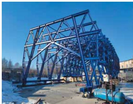
Рис. 6. Сборка механизированной тележки для гидроизоляции
