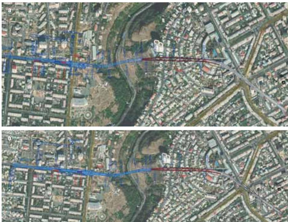
Рис. 3. Трасса линии на плане города проектируемого участка: а – вариант 1; б – вариант 2
