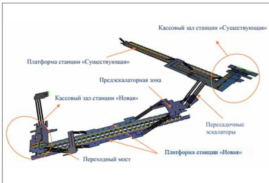
Рис. 1. Модель типовой пересадочной станции в ПК Pathfinder
