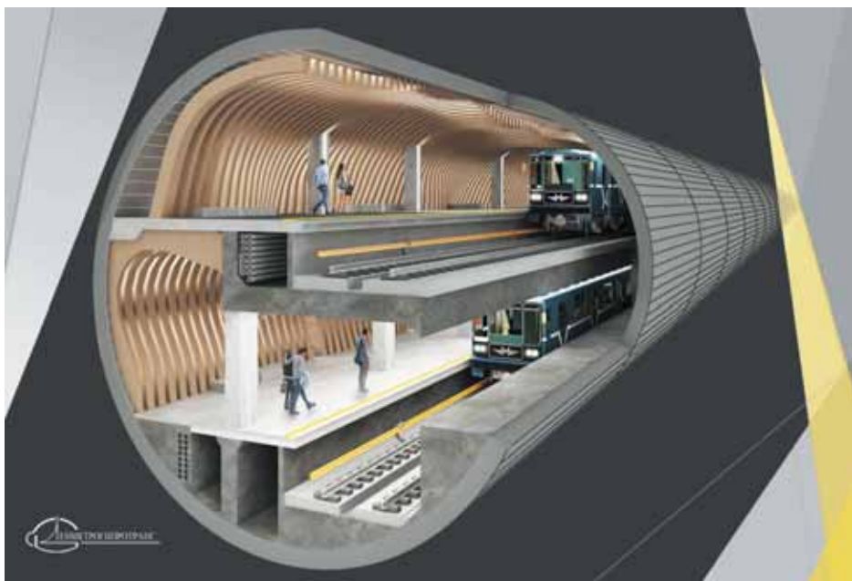
Рис. 4. Размещение станционного комплекса в тоннеле большого диаметра
