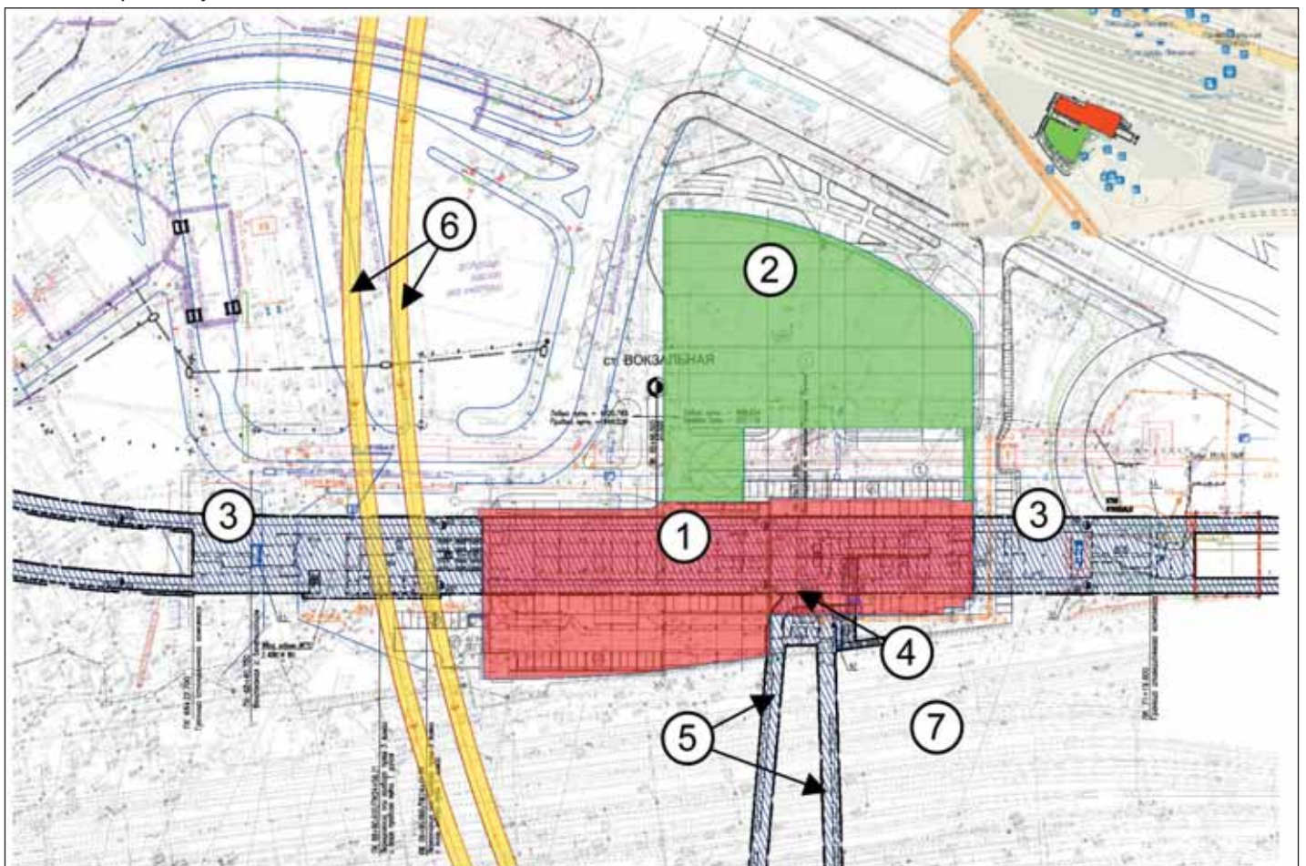
Рис. 9. Ситуационная схема сооружений в районе ст. «Вокзальная»: 1 – торгово-развлекательный комплекс с многоярусным паркингом; 2 – торговый центр; 3 – станция метро «Вокзальная»; 4 – распределительный зал пересадочного узла; 5 – пешеходные тоннели; 6 – тоннели первой линии метро; 7 – железнодорожные пути
