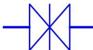
Рисунок 2 – Задвижка в горизонтальной проекции
