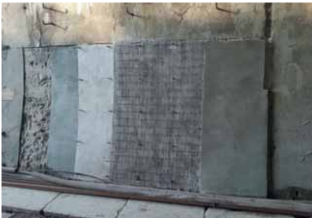
Рис. 6. Опытный стенд. Устройство гидроизоляции несущей «стены в грунте» при поэтапном сооружении двухслойной бетонной конструкции типа «сэндвич» со средней гидроизоляционной прослойкой с двухсторонней адгезией. Слева направо: модель траншейной «стены в грунте»; выравнивающий слой с выпусками анкеров; слой напыляемой гидроизоляции с двухсторонней адгезией; армирующая сетка, слой набрызг-бетона
