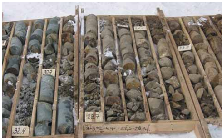
Анализ образцов-кернов грунтобетона при контроле качества работ
