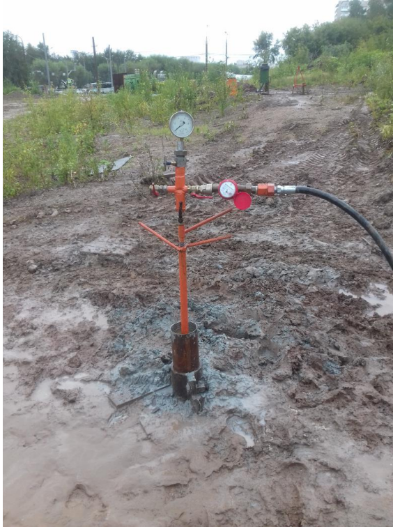
Рис.4. Конструкция и общий вид опытной нагнетательной скважины.
