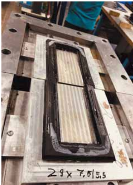
Рис. 13. Лабораторные испытания профилей со смещением в 5 мм
