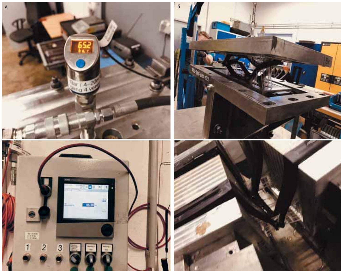
Рис. 14: а – зафиксированное давление воды во время испытаний; б – демонтаж плиты после выполненных испытаний
