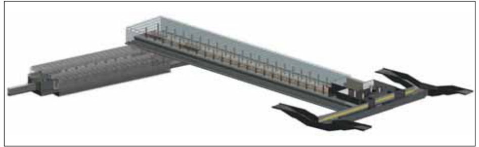
Модель Revit, созданная на основе облака точек (изображение предоставлено АО «Метрогипротранс»)
