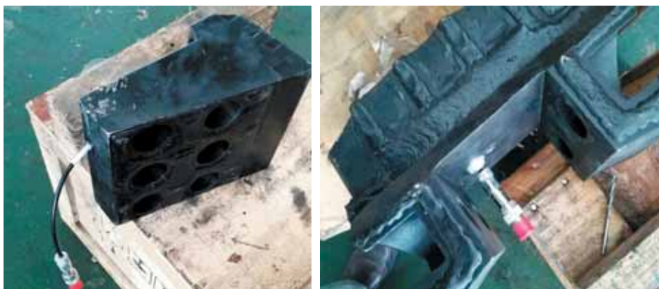
Рис. 10. Датчик износа в резце и ковше
