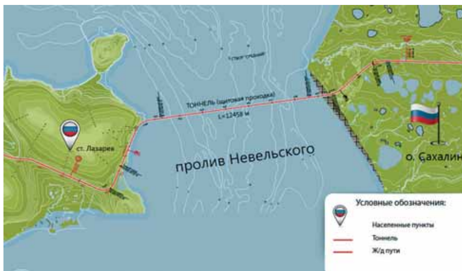
Рис. 1. Тоннельный вариант перехода через пролив Невельского
