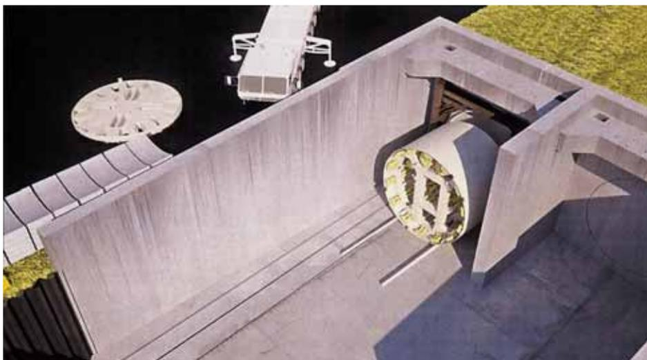
Рис. 2. Виртуальная сборка тоннельной буровой машины (ТБМ) в пробном проекте «Раштаттский тоннель»
