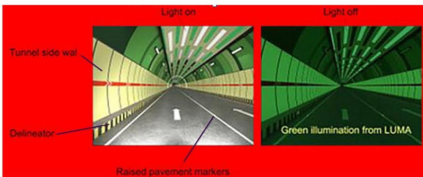
энергосберегающего освещения туннелей разработан многофункциональный материал Лума, обладающий люминесцентными свойствами и свойством накопления энергии. Этот материал применяется для окраски покрытий тоннеля, нанесения разметки на дорожное покрытие и изготовления указателей. Материал Лума не подвержен горению, обладает стойкостью к коррозии и плесени, различным видам загрязнений. Его химические свойства
