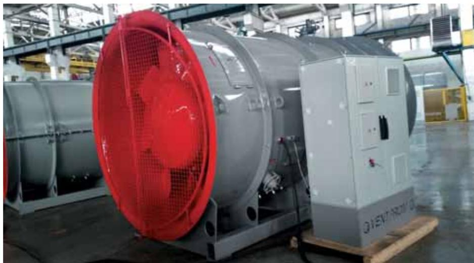
**Рис. 4. Заводские испытания систем САУ-ВОМ совместно с вентилятором**
