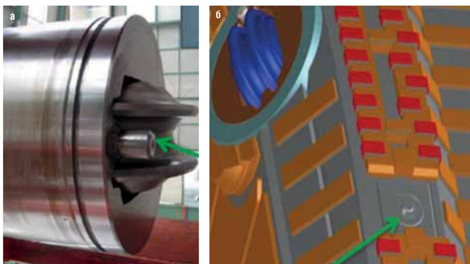
Рис. 2. Датчик износа шарошек (а) и поверхности ротора (б)
