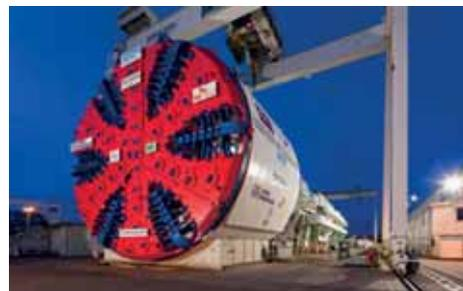
Миксцит диаметром 13,66 м был специально разработан и произведен для проекта в Стамбуле
